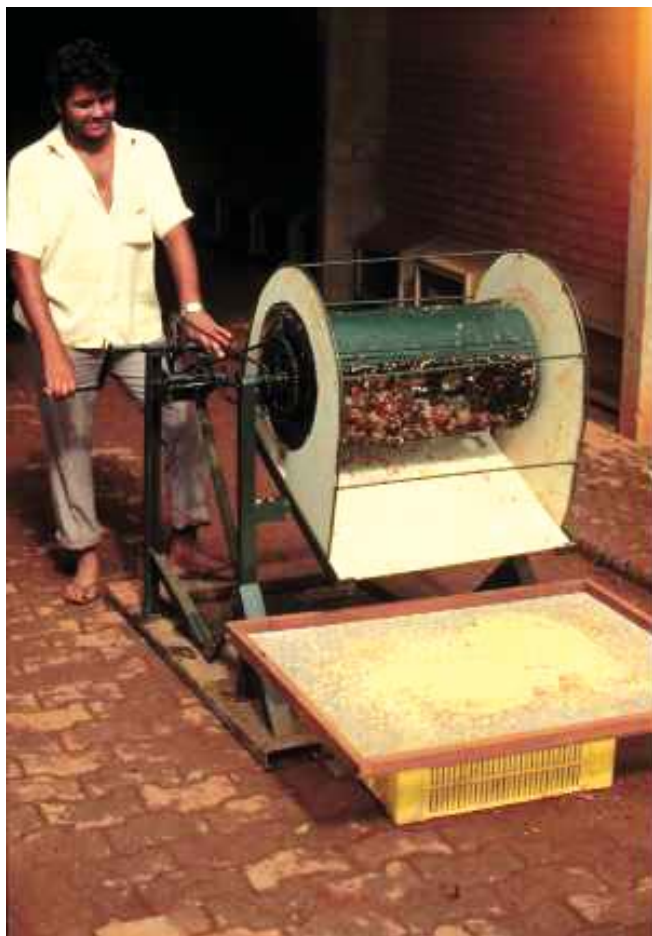
Fig. 8. Equipamento manual para extração de sementes de pimentão.
